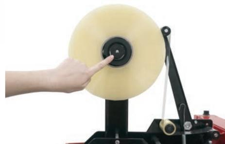
Compruebe el botón de tensión en el mandril para asegurar que la cinta está alimentando correctamente a través de los rodillos.
