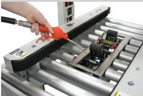
Soplar la máquina con aire seco prestando especial atención a todas las partes móviles.
