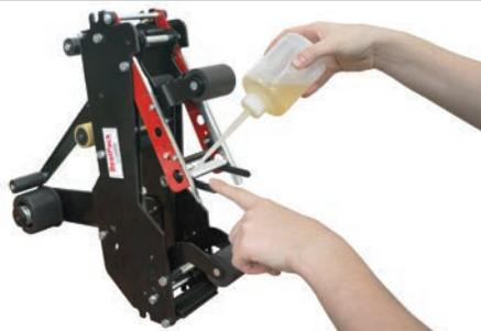
**B)** Lubrique la cuchilla, mediante la aplicación de aceite para la protección del disco. Esto evita que el adhesivo se pegue a la cuchilla.
